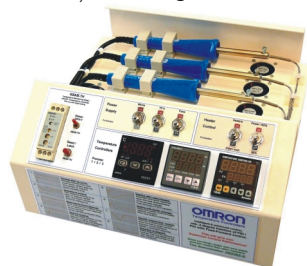
Platformă de teste pentru 3 regulatoare, conectate la 3 procese identice
